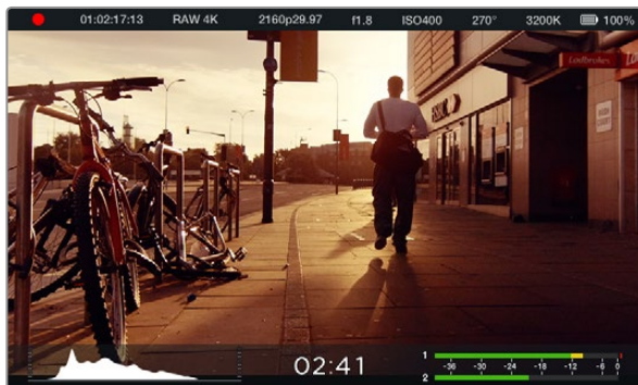
Production Camera 4Kでスクリーンメータリング、ステータスバーを表示
