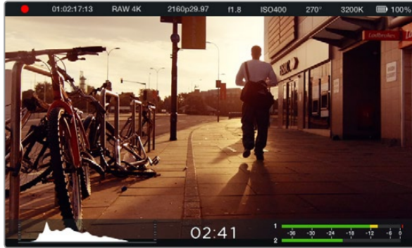
Production Camera 4K Onscreen-Messwertanzeigen und Statusleiste
